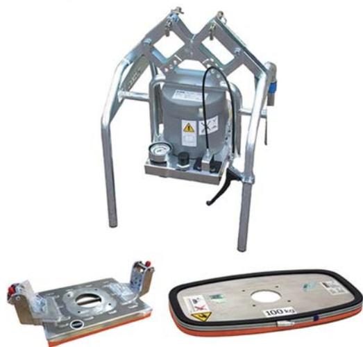
Le modèle AG\_VS permet d'aspirer facilement et rapidement différents types de dalles, même poreuses. Il est équipé de poignées réglables individuellement et repliables facilitant le transport. Ce système peut être également doté de platines d'aspiration interchangeables (utilisation jusqu'à 140 Kg). Il existe aussi en version XL avec des poignées rallongées.
