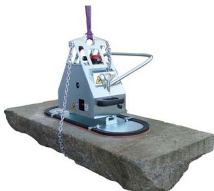
Le modèle AG\_SM permet la préhension par le vide de dalles de pierres, de bordures. Il peut être équipé de platines facilement montées et démontées à l'aide d'un système de serrage rapide. Il dispose d'un crochet de suspension adapté pour un engin de levage. Cet appareil est doté d'une batterie 12 V rechargeable avec un système d'économie d'énergie.
