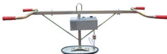
Le modèle AG\_VPH est équipé d'un accumulateur 12V et d'un bouton marche/arrêt permettant d'actionner la pompe d'aspiration. Ce système dispose d'un joint d'étanchéité facilement remplaçable sans colle et sans outil spécifique. Il apporte une meilleure précision dans la pose de la charge, avec la possibilité d'ajuster au mieux la position, et préservant l'état des arêtes.
